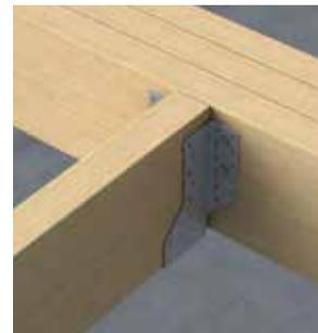
Für den Einsatz bei Schwerlastanwendungen, wie z. B. bei Mehrfachträgerereinheiten, Hauptstützbalken, Pfetten-/Balkenverbindungen oder ähnlichen Anwendungen, in denen ungewöhnlich hohe Belastungen auftreten. Die Auflagefläche bei allen Mehrfachträger-Balkenschuhen beträgt 75 mm. **Kartoninhalt 50.**
